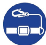
墜落制止用器具使用
