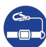
墜落制止用器具使用
