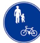
普通自転車及び特例特定小型原動機付自転車以外の車両の通行を禁止する標識です。
